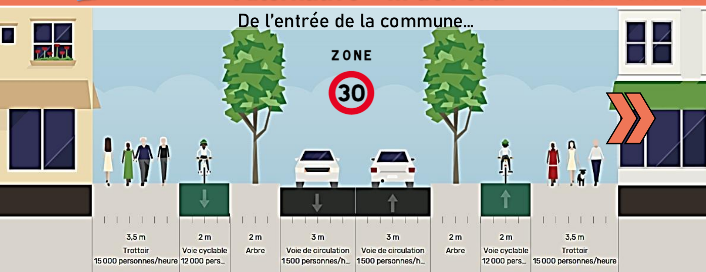
Route de Dourdan en ZONE 30 à double-sens avec piste cyclable unidirectionnelle de part et d'autre de la voirie (profil de 21 m)
