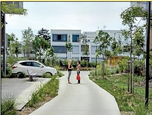
Quartier en zone de rencontre. La chaussée est dimensionnée à 3,5 m, entourée de verdure et de plantations. La rue est à double sens cyclable, elle accueille le cheminement de tous. Avec cette chaussée unique, l'automobiliste sait qu'il peut rencontrer des piétons et des cyclistes.
