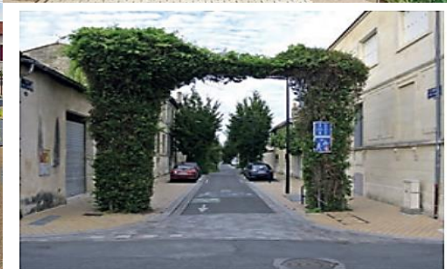
Cette entrée de zone de rencontre est matérialisée par un effet de porte. L'entrée est visible de loin, repérable et identifiable. Le masque à la visibilité que constitue la porte est compensé par la faible vitesse des véhicules et la priorité absolue du piéton.
